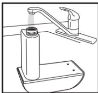
3. Remplissez le bac avec de l'eau claire et fraîche (non froide). Nous conseillons l'utilisation de l'eau distillée si vous vivez dans un endroit où l'eau est dure. **N'utilisez pas d'additifs et n'ajoutez pas d'huiles essentielles à l'eau. Quelques gouttes suffisent à endommager l'appareil.**
