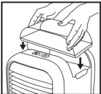
5. Posez le bac dans la cavité du MyChill, tout en veillant à ce que le bac soit fermement fixé. L'eau va commencer à passer vers le réservoir d'eau.
