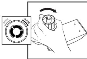
4. Vissez à fond le bouchon du bac en tournant dans le sens des aiguilles d'une montre. Ne vissez pas outre mesure.
