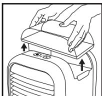
1. Desenchufe el adaptador de corriente de la pared y de la unidad. Retire el tanque de agua de la carcasa superior.
