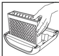
4. Fixez le nouveau dispositif de refroidissement en place. Assurez-vous que le dispositif de refroidissement est placé de façon à ce que les fentes de ventilations en forme de « V » soient orientées vers le haut.
