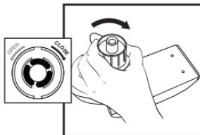
4. Vuelva a colocar el tapón del tanque al girarlo en sentido horario hasta que esté ajustado. No sobreajustar.
