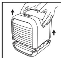
2. Levante suavemente y retire la cubierta superior del enfriador de espacio personal. Elimine cualquier exceso de agua restante en el depósito de agua.
