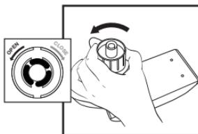
2. Enlevez le bac d'eau et retournez-le – enlevez le bouchon du bac en tournant dans le sens inverse des aiguilles d'une montre.
