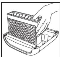
1. Veillez à ce que le dispositif de refroidissement soit placé de façon à ce que les fentes de ventilations en forme de « V » soient orientées vers le haut. **Ne faites jamais fonctionner l'appareil sans son dispositif de refroidissement.**
