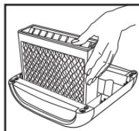
4. Coloque el nuevo medio de enfriamiento en el lugar. Asegúrese de que el medio enfriador está posicionado con las ventilaciones "con forma de V" hacia arriba.
