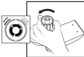
2. Retire el tanque de agua y ponga el tanque boca abajo, retire el tapón del tanque al girarlo en sentido antihorario.
