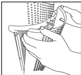
1. Débrancher le purificateur d'air. Tirer sur les encoches de chaque côté de la grille.
