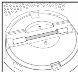
2. Retirer le couvercle pour exposer l'ampoule UV-C.
