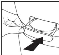
5. Replacer le plateau d'aromathérapie dans son compartiment et pousser pour fermer. L'arôme se libère automatiquement lorsque le purificateur d'air est mis en marche.
