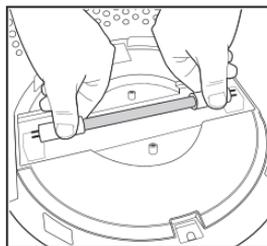
4. Retirer l'ampoule UV-C et la remplacer. Réinstaller le couvercle de l'ampoule UV-C, le filtre True HEPA et la grille.
