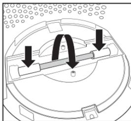
3. Pousser délicatement sur les côtés et faire pivoter l'ampoule UV-C pour la retirer.
