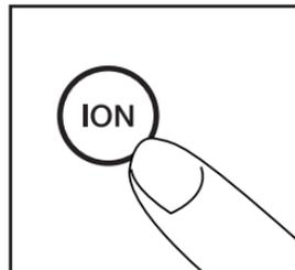
6. Brancher le cordon d'alimentation dans une prise secteur standard et appuyer sur le bouton ⏻ de mise en marche. Appuyer pendant 3 secondes sur le bouton ION de l'ionisateur pour réinitialiser le voyant.
