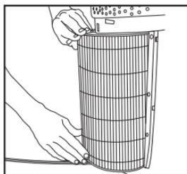
4. Avec les languettes du filtre face vers l'extérieur, insérer le filtre True HEPA neuf.
