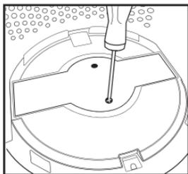
1. Débrancher le purificateur d'air et retirer le filtre de True HEPA. Utiliser un tournevis cruciforme (non fourni), et dévisser les deux vis situées sur le couvercle de l'ampoule UV-C.
