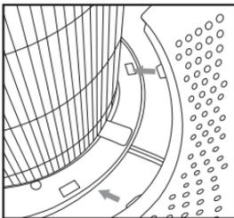
5. Placer les languettes situées en bas de la grille dans le socle du purificateur d'air. Appuyer délicatement sur la grille jusqu'à ce qu'elle s'enclenche en position.
